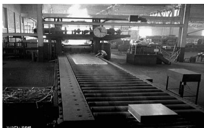
Laminage à chaud de brames d'aluminium.
