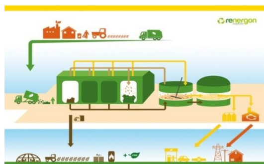
Unité de méthanisation de la ferme de Sockeel (59). Cela permet la production de biogaz à partir de déchets organiques. L'activité agricole a été ici pensée en matière de circularité.
