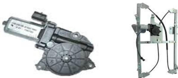
Moteur électrique d'un lève vitre et système complet du dispositif.
