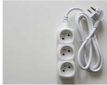
Un bloc multiprise permet de réduire les coûts de revient et d'encombrement afin d'alimenter des équipements électriques. Ici il s'agit toutefois d'une multiprise non conçue en circularité industrielle car non démontable. C'est-à-dire non réparable (un choix d'assemblage non par visserie mais par sertissage). Contrairement à la conception d'un pneumatique, l'alignement des trois critères coût/fonction/écologie était toutefois ici aisé à conduire.
