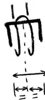
Fig. 3. Installer un tapis « au milieu » de l'élingue
