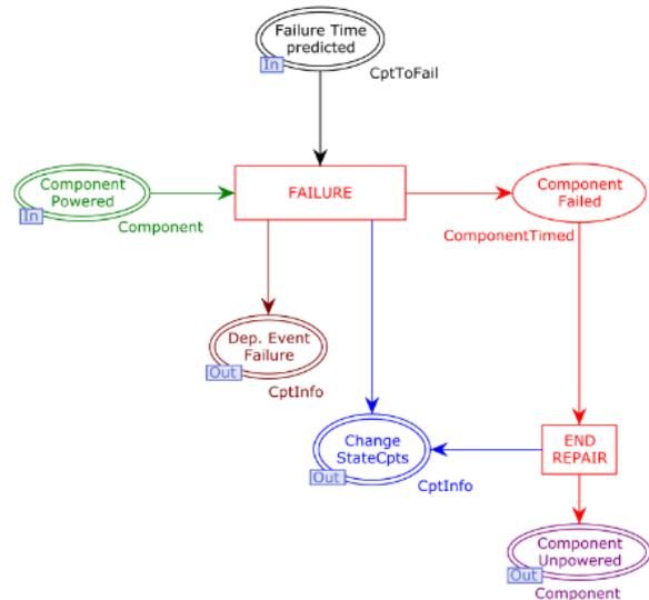
Fig. 9. RdP décrivant le comportement d'un composant après l'occurrence d'une défaillance et la fin d'une réparation.
