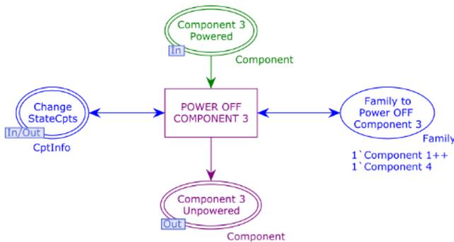
Fig. 10. RdP décrivant le comportement du composant n°3 se mettant hors tension à cause du composant n°1 ou n°4.
