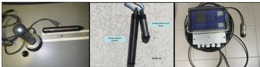
FIG.12 — SONDES SOLINST : LEVELOGGER (DANS SON SABOT DE TRANSFERT DE DONNÉES) ET BAROLOGGER (GAUCHE), MINIDIVER (CENTRE) ; SONDE DE PRESSION KELLER ET CENTRALE SOLOPHÈME (DROITE)
