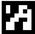
Fig. 1 : Illustration d'un marqueur ArUco
