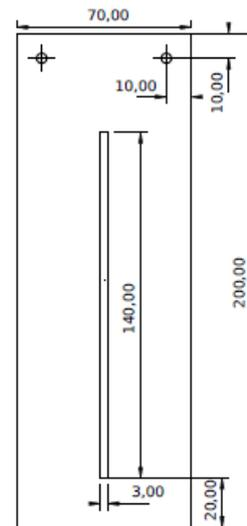
Fig.6 : Dimensions de la mire « à fente »
