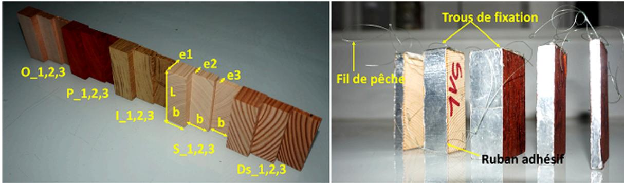
Fig. 1 : Configuration des éprouvettes testées Fig. 2 : éprouvettes après la mise du ruban
