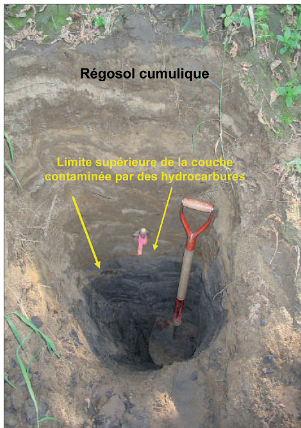
FIGURE 2 SOL CONTAMINÉ AVEC LA PRÉSENCE D'UNE COUCHE D'HYDROCARBURES (C 10 -C 50 ) À LA BASE DU PROFIL (rive droite de la rivière Massawippi en aval de la mine Eustis)
