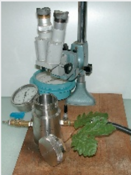
Mesure du potentiel hydrique d'un rameau de chêne à la bombe de Scholander Photo Nathalie BRÉDA
