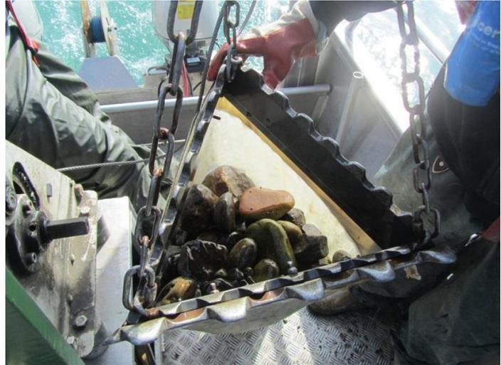
**Figure 8 : Drague CNR suspendue à la potence lors de la remontée (à gauche) et pleine de sédiments (à droite)**
