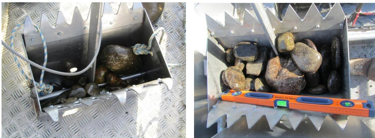
**Figure 10 : A gauche : petite CS remontée avec quelques particules. A droite : grande CS remplie avec les sédiments remontés par la drague CNR**
