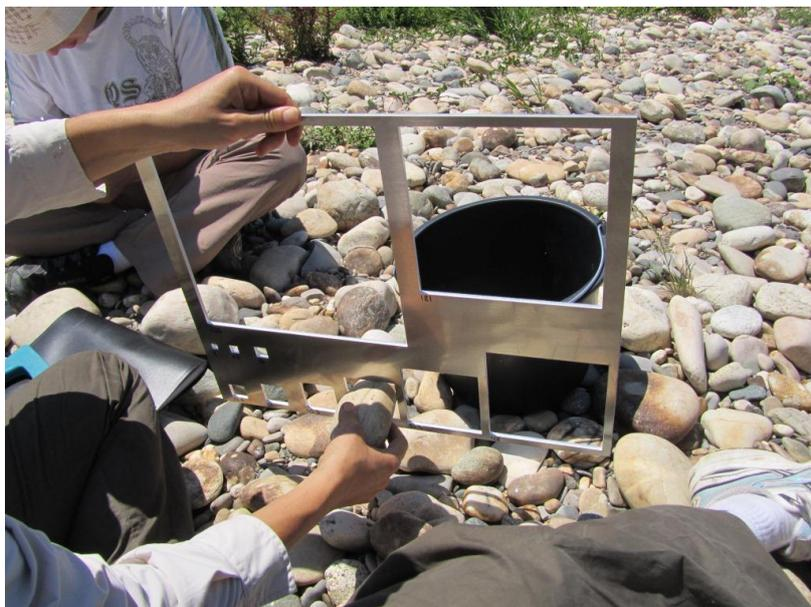
Figure 11 : Gabarit standard permettant d'estimer la gamme de taille des particules selon le plus petit axe (axe b)
