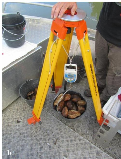
Figure 15 : a. Mesures granulométriques des particules les plus grossières réalisées avec un gabarit directement sur le bateau b. système pour peser chaque classe de tailles
