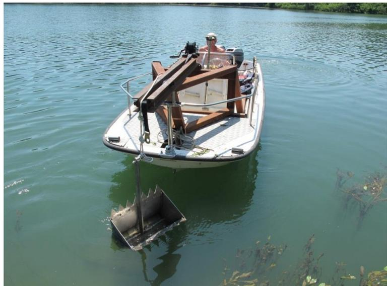
Figure 6 : A gauche : les préleveurs Cooper Scooper (grand à gauche et petit à droite), calibrés par Mike Singer (au milieu). En haut : le bateau de l'Irstea utilisé lors des essais et la grosse Cooper Scooper.
