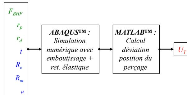
FIGURE 4 – Chaîne de calculs et paramètres d'entrée/sortie
