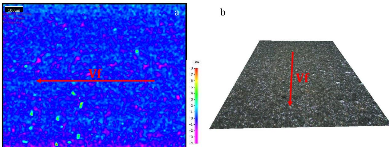
Fig 9: Représentation en fausses couleurs de la surface obtenue après usinage en bout  $\theta=0^\circ$  et  $V_f=1000\text{mm/min}$
