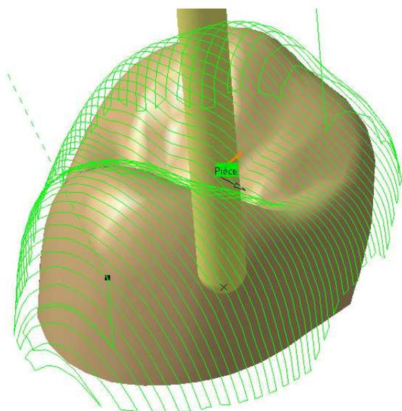
Fig 2 : Trajectoire 3 axes (plans parallèles) pour un outil conique sur un extrados coronaire de prémolaire n°15.
