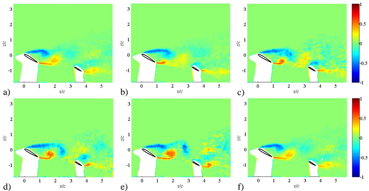
Figure 10 : Moyennes de phase du critère  $\Gamma_2$  pour  $\alpha = 30^\circ$ ,  $\ell_x = 3,19 c$  and  $\ell_z = c$  : a)  $\phi = 0^\circ$ , b)  $\phi = 72^\circ$ , c)  $\phi = 144^\circ$ , d)  $\phi = 216^\circ$ , e)  $\phi = 288^\circ$ , f)  $\phi = 360^\circ$ .
