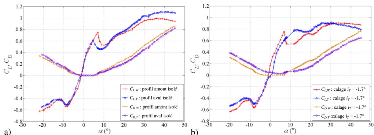
Figure 5 : Évolution des coefficients de portance et de traînée des profils amont et aval en fonction de l'angle d'incidence : a) profils isolés, b) profils distants de  $\ell_x = 3,19 c$  et de  $\ell_z = c$ .
