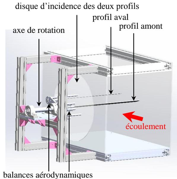
Figure 2 : Section d'essai et dispositif expérimental.
