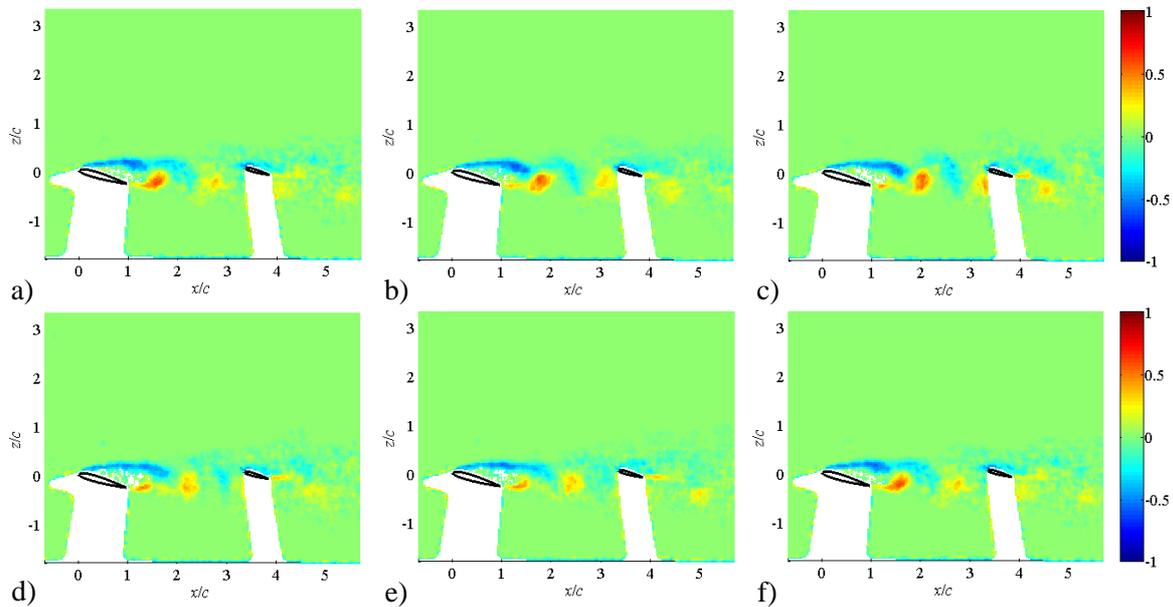
Figure 9 : Moyennes de phase du critère  $\Gamma_2$  pour  $\alpha = 15^\circ$ ,  $\ell_x = 3,19 c$  and  $\ell_z = c$  : a)  $\phi = 0^\circ$ , b)  $\phi = 72^\circ$ , c)  $\phi = 144^\circ$ , d)  $\phi = 216^\circ$ , e)  $\phi = 288^\circ$ , f)  $\phi = 360^\circ$ .
