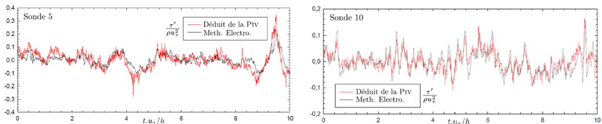
Figure 4: Comparaison des fluctuations de frottement pariétal obtenues par méthode électrochimique avec celles déduites des champs fluctuants PIV, pour les sondes 5 et 10 respectivement aux positions  $x^* = 0.72$  et  $x^* = 1.15$ .
