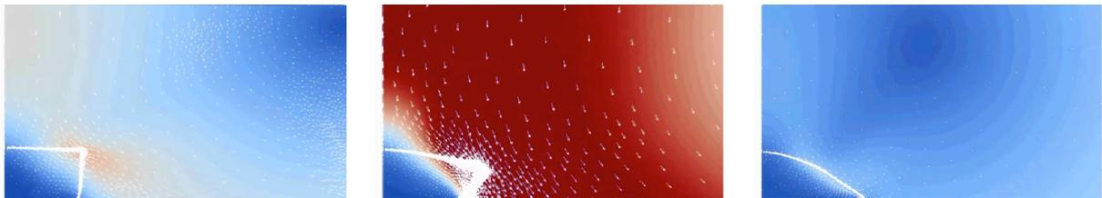
Figure 4 – Champ des vitesses pour un fluide dont le comportement dépend de la pression, la chute s'effectue par le haut, et la forme finale respecte l'angle de tas (coefficient de frottement  $\mu_s$  statique)
