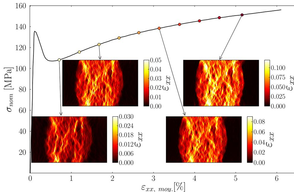
FIGURE 2 – Évolution de la déformation axiale lors de l'essai de traction
