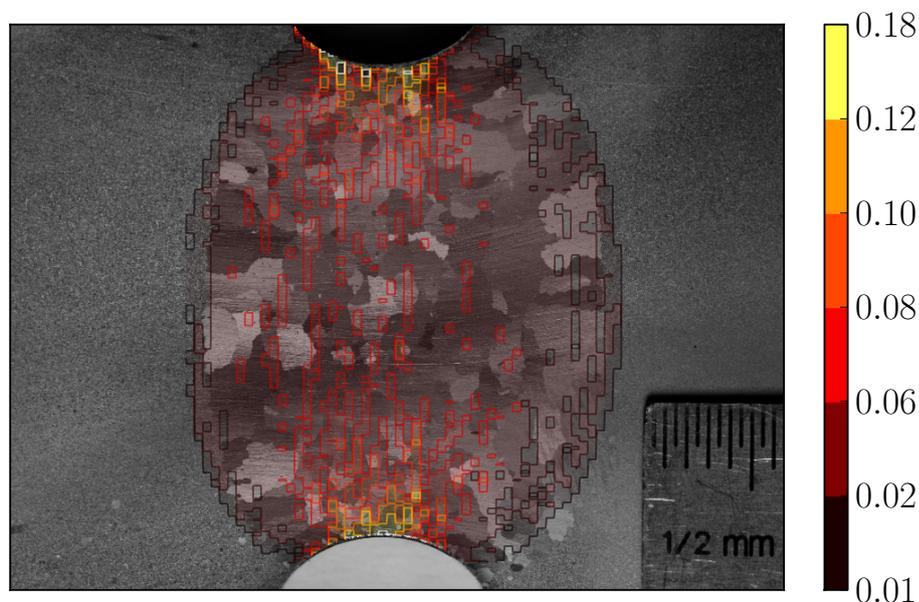
FIGURE 1 – Déformation axiale obtenue par C.I.N. et microstructure recristallisée (1h à 800°C)
