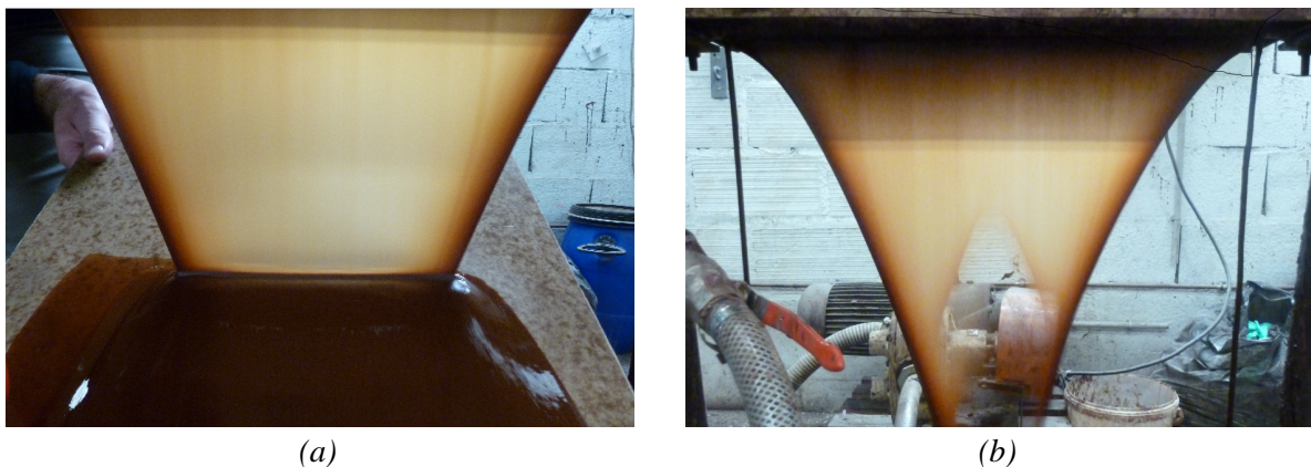
Fig. 1 : Photographies de l'écoulement en rideau sans guide du mélange collant de résine (pilote industriel): a) écoulement stable ; b) rupture de la nappe liquide et propagation d'un trou (Crédit photo Rolkem).
