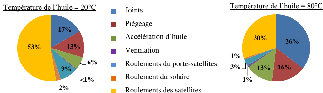
Figure 10 – Distribution des pertes de puissance dans le réducteur d'essai pour une vitesse de rotation de 2000 tr/min et un débit de 2 l/min dans chaque circuit
