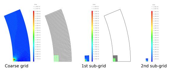
Figure 6 – Exemple for the 2D(r, $\theta$ ) test case  $\cdot$  Coarse mesh size : 54.5  $\mu$ m  $\cdot$   $\beta=1\%$
