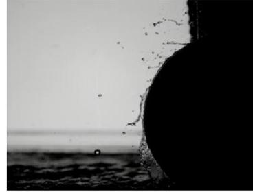
*Comparaison entre entraînement d'eau sans vitesse moyenne (à gauche) et avec vitesse moyenne (à droite, entraînement du liquide via un tapis roulant) : l'entraînement d'eau réduit la quantité d'eau entraînée, mais augmente la fragmentation liquide*
