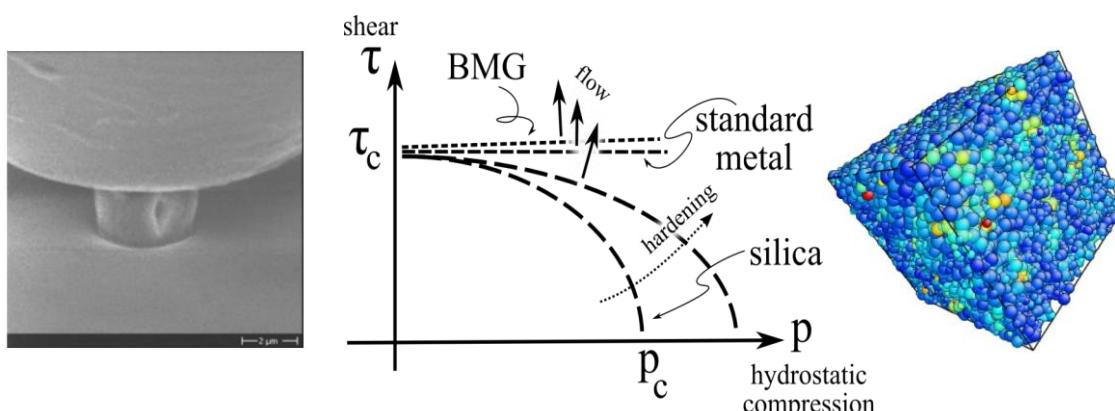
Figure : à gauche compression *in situ* de pilier de silice amorphe (diamètre 3 microns) – au centre : surface de charge de la silice amorphe tracée dans un plan pression hydrostatique - contrainte de von Mises, et comparée au critères classiques pour les métaux (standard metal), ainsi que pour les verres métalliques (BMG) ; à droite, volume représentatif dans le calcul de la réponse en compression hydrostatique de la silice amorphe par Dynamique Moléculaire
