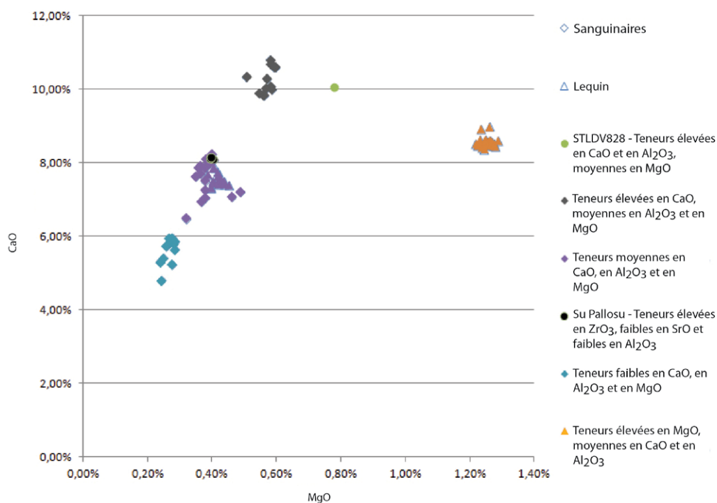
Figure 7 : Diagramme binaire des teneurs en chaux et en magnésie des verres bruts bleus analysés avec le classement par groupes de compositions.
