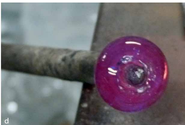
Figure 61 : Percement d'une galette de verre. a. le verre cueilli est modelé pour former une galette à l'extrémité du ferret. b. la galette est détachée du ferret et posée sur une surface plane et propre. Le point d'attache du ferret est encore visible. c. La galette est retournée et le ferret est enfoncé à travers la galette, il la perce. d. la galette est percée.
