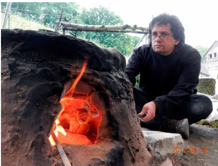
Figure 103 : Photos de fabrication de bracelets sur le deuxième four construit à la citadelle d'Amiens. En bas, au premier plan, on aperçoit à travers l'un des ouvertures l'intérieur du four. Un creuset repose sur la margelle.
