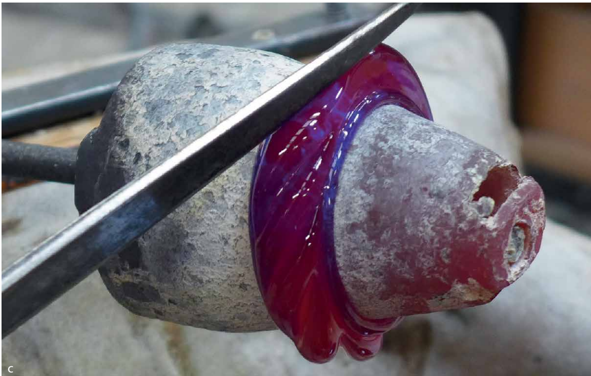
Figure 78 : Photos (a à c) et schéma (d) de l'incision des côtes en biais sur le jonc central des bracelets, avec ou sans support conique.
