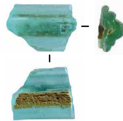
Lattes (34) LSS 1986 US 1318 P3 .688 Verre à la coloration naturelle analyse n°641 Verre jaune analyse n°637
