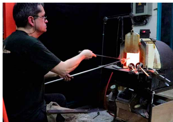
Figure 50 : Production de bracelets en verre dans l'atelier de Silicybine, sur l'un des deux fours à gaz adaptés à une position de travail assise. Ce four a été fabriqué pour réaliser principalement des bracelets. Sa petite taille et ses petits creusets permettent un travail plus près de l'ouvreur.
