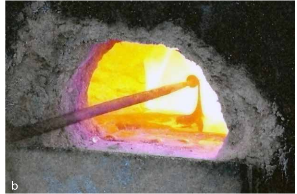
Figure 62 : a. Fabrication d'une perle par enroulement de verre par Guillaume Masclef. b. Détail de l'enroulement. Le verre est soulevé par un crochet et ensuite enroulé sur un ferret.
