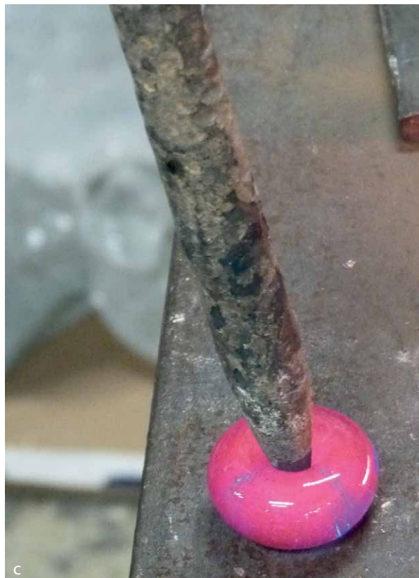
Figure 61 : Percement d'une galette de verre. a. le verre cueilli est modelé pour former une galette à l'extrémité du ferret. b. la galette est détachée du ferret et posée sur une surface plane et propre. Le point d'attache du ferret est encore visible. c. La galette est retournée et le ferret est enfoncé à travers la galette, il la perce. d. la galette est percée.
