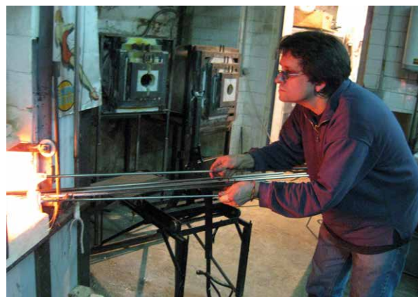
Figure 49 : Première expérimentation sur les techniques de fabrication des bracelets. Les fours utilisés pour le verre soufflé se révèlent inadaptés à la production de bracelets qui demande de travailler près du four.
