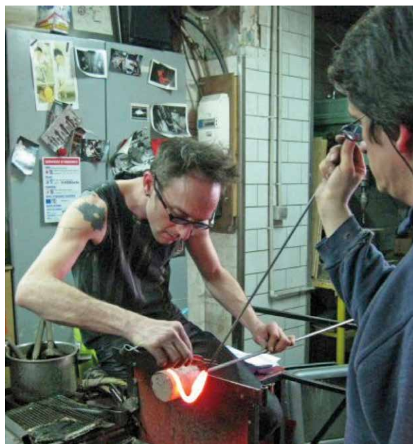
Figure 46 : Premières expérimentations des techniques de fabrication des bracelets en verre par enroulement.
