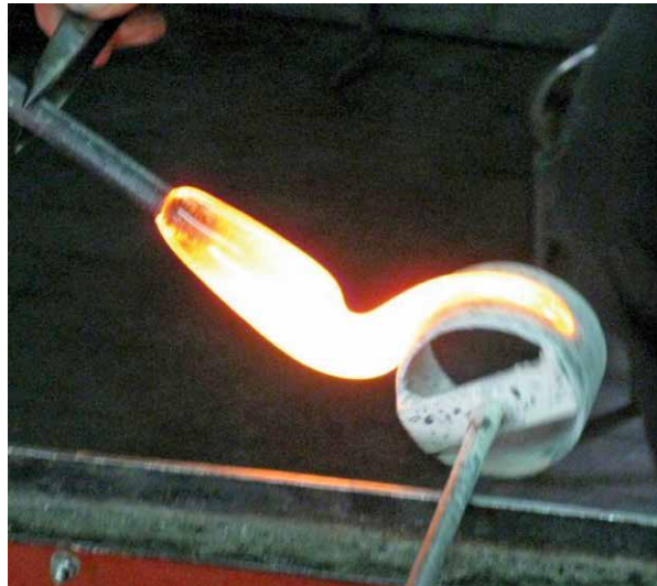
Figure 45 : Enroulement d'un cordon de verre chaud autour d'un mandrin cylindrique. Malgré la finesse du cordon l'anneau obtenu présente une soudure.
