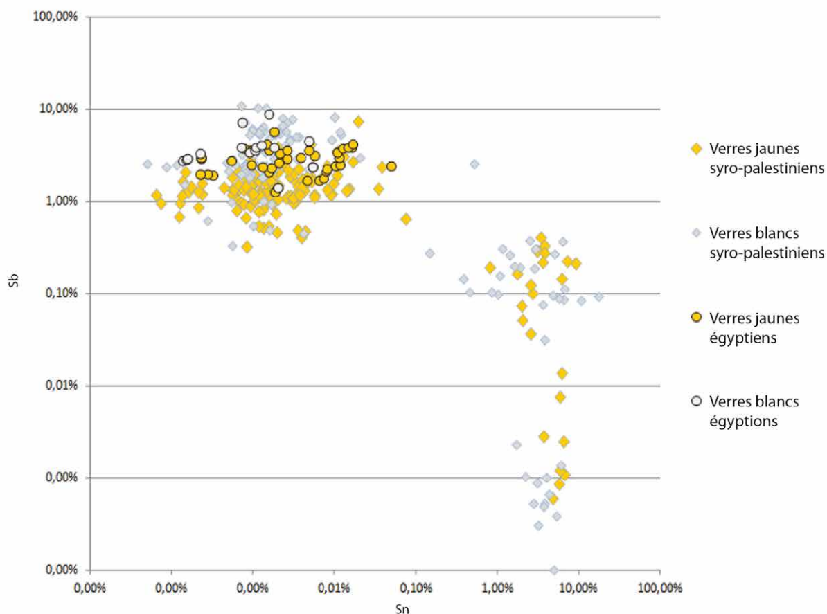
Figure 39 : Diagramme binaire représentant les teneurs en Sb et Sn dans les verres opaques jaunes et blancs analysés.
