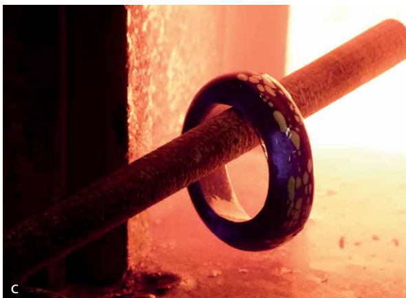
Figure 92 : a. et b. : étapes de la réalisation d'une perle de type Haevernick 24 ; c. : la perle peut être agrandie pour réaliser un bracelet en verre de type Haevernick 3c. Résultats de l'expérimentation en d.
