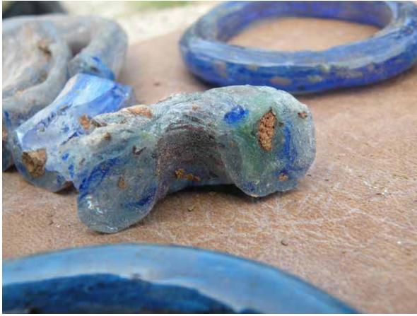
Figure 104 : Photo de résultats de l'expérimentation sur le premier le four construit à la citadelle d'Amiens. Des températures de travail basses et une mauvaise maîtrise de la propreté du verre donnent des résultats salis et un verre qui « file » et qui n'est pas homogène.
