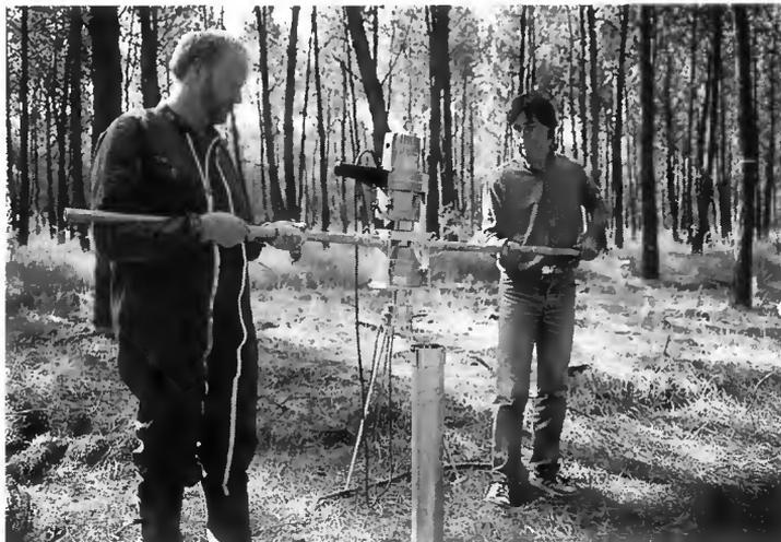
Utilisation d'une foreuse à moteur pour prélever des carottes de terre de 10 cm de diamètre et de 1 m de long
