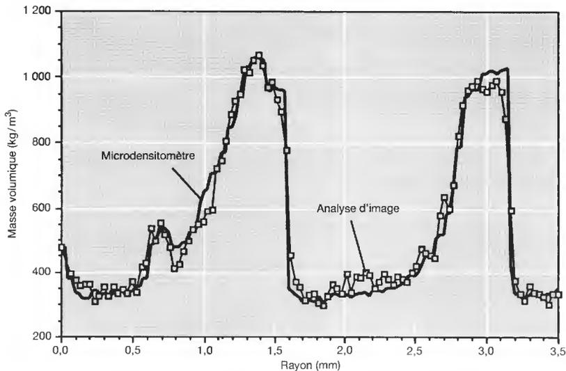
La mesure par microdensitométrie est effectuée par l'ERQB (INRA) à partir de radiographies. L'autre courbe est obtenue par sélection automatique des parois cellulaires sur des coupes microscopiques (d'après Lahbabi, 1992)
