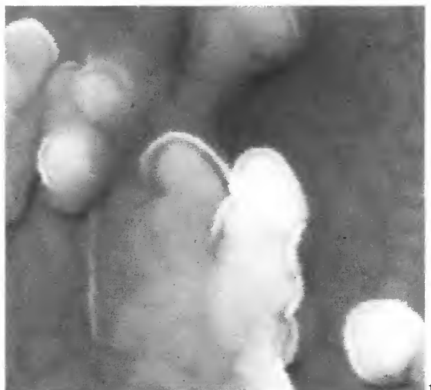
Figure 12 DÉTAILS DES FAISCEAUX DES MICROFIBRILLES ( \times 15\ 000 ) sur la structure de type nid d'abeille des ponctuations intervasculaires des vaisseaux.
