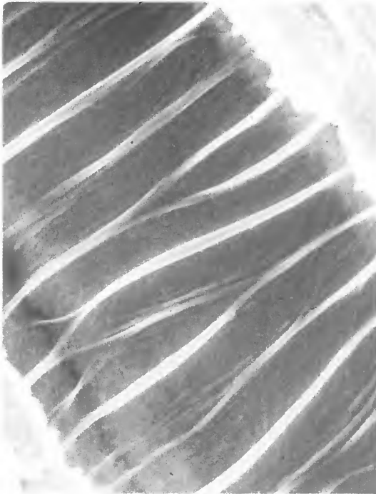
Figure 10 MICROFIBRILLES DU BOIS FINAL OBSERVABLE SUR LA PAROI TANGENTIELLE ( \times 7\ 000 ). L'angle des microfibrilles peut être mesuré par rapport à la paroi qui est légèrement délamérée.
