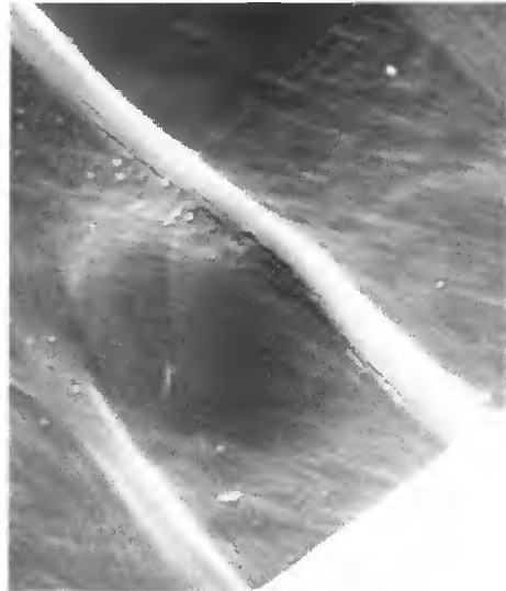
Figure 10 MICROFIBRILLES DU BOIS FINAL OBSERVABLE SUR LA PAROI TANGENTIELLE ( \times 7\ 000 ). L'angle des microfibrilles peut être mesuré par rapport à la paroi qui est légèrement délamérée.
