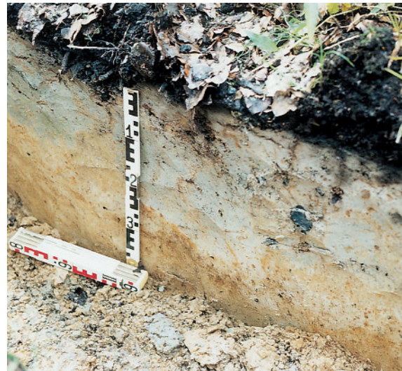
Photo 4 Coupe verticale dans un sol compacté en hêtraie. Le profil est perpendiculaire à l'axe du layon de débardage ; on distingue nettement la zone grise superficielle déferrifiée (horizon E 0 ) ainsi que les taches et concrétions ferro-manganiques qui se sont formées à la base de l'horizon éluvial et au sommet du B textural (horizon B tg ), vers 30 cm de profondeur
