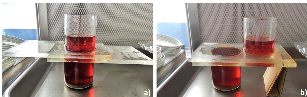
Figure 2 – Récupération du surnageant après isolement des MP de 30 g de sédiment avec le dispositif de séparation JAMSS a) décantation, b) séparation
