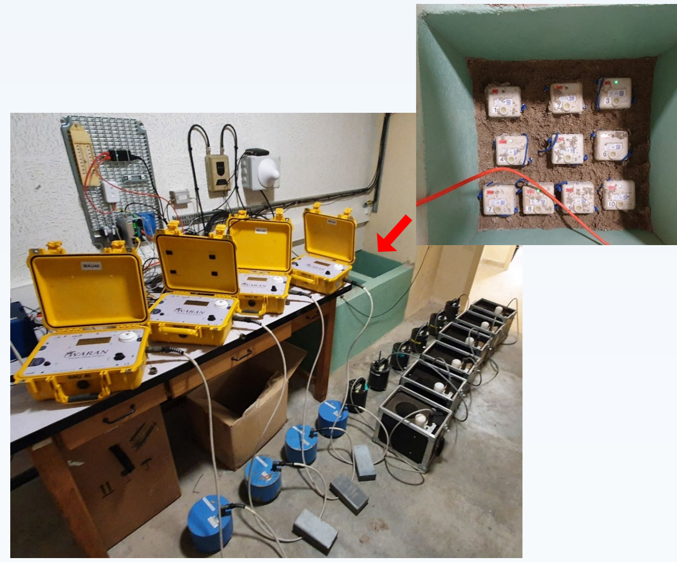
Fig 1. Photo d'un huddle-test mis en place dans la cave sismique de Cadarache.
