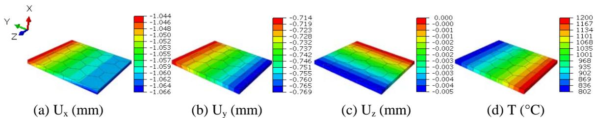
FIG. 3 – Répartition spatiale des conditions de chargements à la température maximale de la dernière passe ( $t = 20 \cdot 10^4$  s).
