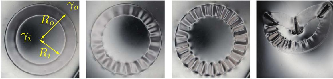
FIGURE 1 – Apparition de rides orthoradiales sur un anneau étroit flottant à la surface de l’eau lorsque des molécules tensio-actives sont ajoutées à l’extérieur de l’anneau. Au delà d’une concentration de tensio-actif trop importante, l’anneau peut s’effondrer brutalement.
