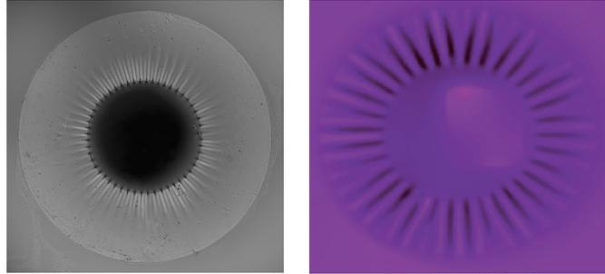
FIGURE 2 – Rides sur un anneau large ( $R_i \ll R_o$ ). La longueur des rides croît avec la concentration de tensio-actif. Initialement constant, le nombre de rides finit par augmenter si la longueur d’onde locale des rides devient trop grande par rapport à sa longueur d’onde initiale.
