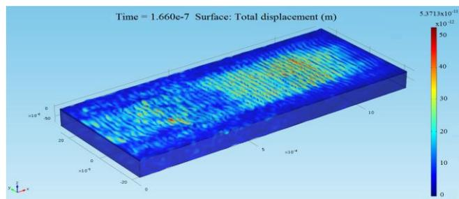
FIG. 2 – Propagation d'une onde de Love à  $t = 16,6 \mu\text{s}$ .
