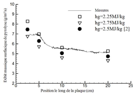
FIG. 4— Effet de la chaleur de gazéification sur le débit local de pyrolyse stationnaire.
