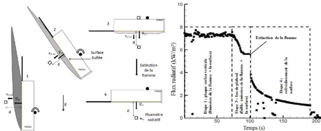
FIG. 3 – a) Dispositif expérimental et procédure, b) évolution temporelle du flux radiatif issu de la flamme mesuré par le capteur localisé face à l'échantillon à la distance de 10 cm et durées des étapes 1 à 4 correspondant aux phases décrites en a).
