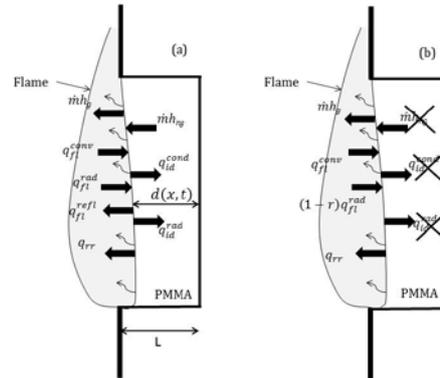
FIG. 1 – Problème physique a) instationnaire et b) dégradation stationnaire d'une plaque de PMMA thermiquement épaisse.
