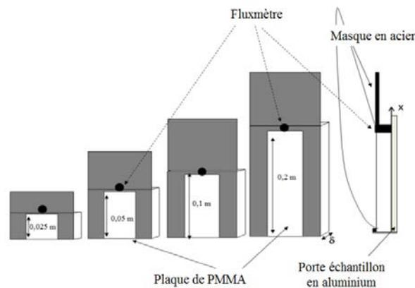
FIG. 2 – Dispositif expérimental
