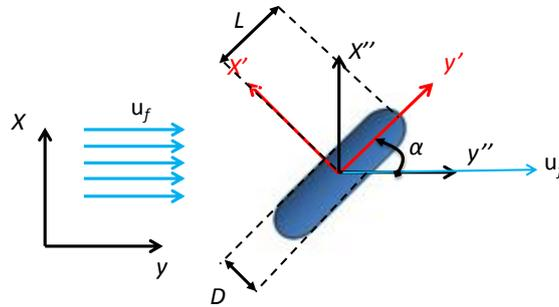
FIG. 1 – Sphéro-cylindre considéré avec un angle d'incidence  $\alpha$ .
