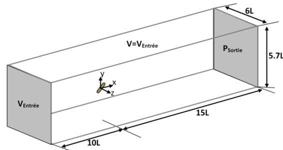
FIG. 2 – Domaine de simulation et conditions aux limites
