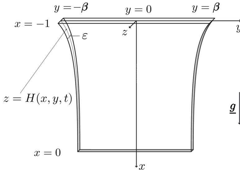
FIGURE 1 – Un fluide de viscosité  $\mu$  est injecté à une vitesse  $U$  par une fente horizontale. Il s'écoule verticalement en formant un rideau et accélère sous l'effet de la gravité. Sa largeur diminue par un effet Poisson qui donnera naissance à des contraintes compressives dans le corps du rideau.
