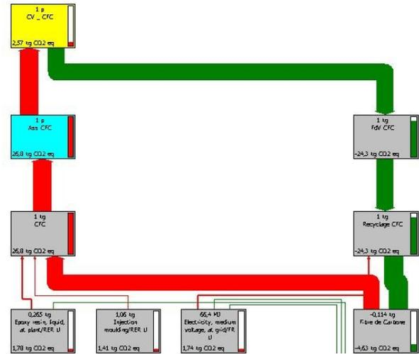
Figure 3. Détail de la visualisation en réseau des impacts du cycle de vie d'une pièce composite de 1 kg avec recyclage des fibres de carbone, sur le potentiel de réchauffement climatique (en kg CO<sub>2</sub> eq.)
