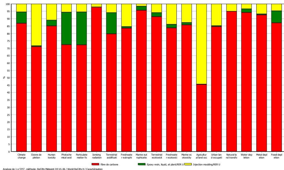
**Figure 1.** Analyse de l'impact de la fabrication de 1 kg de composite à renfort carbone (CFC), selon la méthode de calcul d'impact ReCiPe Midpoint (H) basée sur les données de Duflo et al. [2] (rouge = renfort carbone, vert = matrice époxy, jaune = procédé de mise en œuvre)
