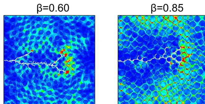
FIGURE 4 – Champ de densité d'énergie élastique en cours de fissuration ( $t = 0.2$ ) de matériaux composites pour deux valeurs du facteur de réduction des grains  $\beta$ , le ratio entre ténacité des grains et ténacité de l'interface étant  $K_{GG}/K_{MG} = 5.0$ . Echelles de couleurs identiques.
