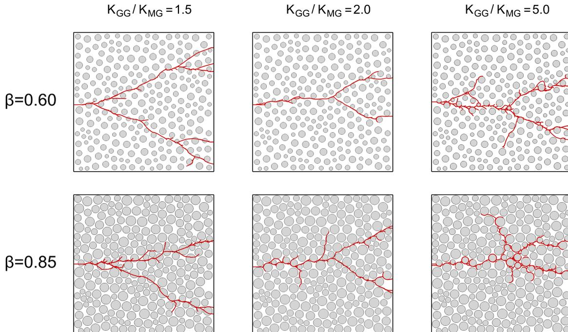
FIGURE 3 – Fissuration de matériaux composites pour deux valeurs du facteur de réduction des grains  $\beta$  et trois valeurs du ratio entre ténacité des grains et ténacité de l'interface  $K_{GG}/K_{MG}$ .
