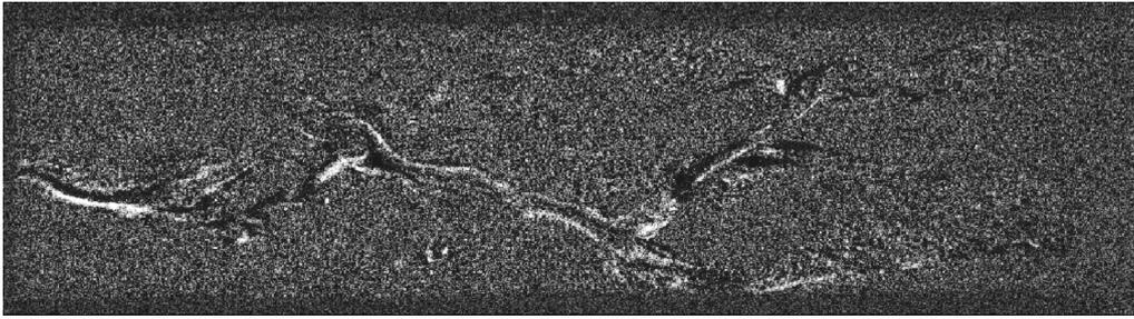
FIGURE 4 – Éxperience d’écoulement de Carbopol en fracture hétérogène. Proche du seuil d’écoulement, quelques chemins seulement s’écoulent.
