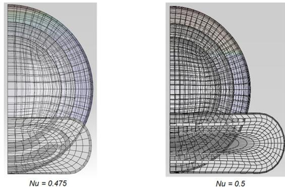
Figure 4: retrait latéral – coefficient de Poisson
