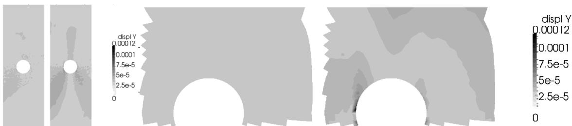
**Fig. 5 Cartes de résidus des déplacements verticaux pour différents chargements. A gauche : déplacement en champ lointain, à droite en champ proche.**
