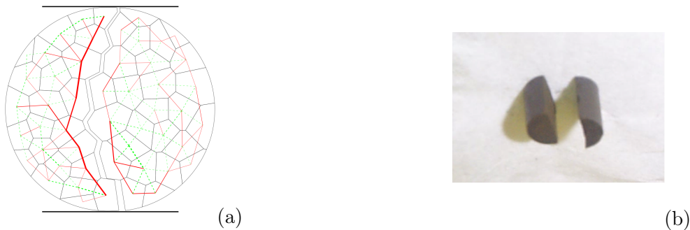
FIGURE 5 – (a) Particule fragmentée diamétralement à la fin de l'essai brésilien (force de compression en rouge, force de traction en vert), (b) Comprimé d' \text{UO}_2 fragmenté lors d'un essai brésilien.
