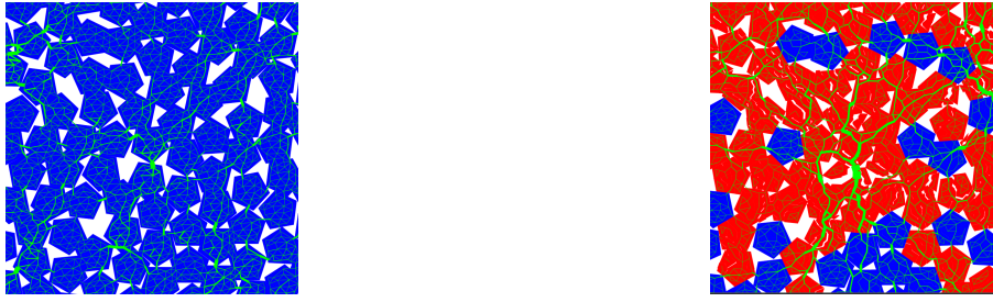
FIGURE 10 – Vue de l'échantillon au début et au cours de la compaction (particules non fragmentées en bleu, particules fragmentées en rouge et réseau des forces normales en vert)
