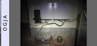
La station sismo (automates ABAC, caisse de batterie et capteur vélocimétrique) est installée dans le bloc 2 du fort, dans la salle des canons mortiers (désaffectés, on a vérifié).
