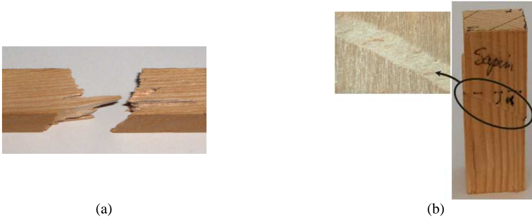
FIG. 2 – (a) Rupture en flexion 3 points, (b) Bande de cisaillement apparue lors d'une compression.
