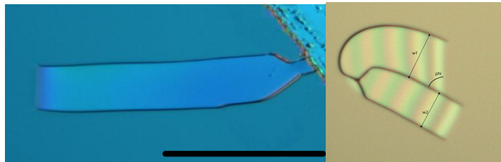
FIGURE 2 – (a) Coopération entre rupture et délaminage lors de la propagation de deux fissures parallèles dans un film d'épaisseur h=1.4\ \mu\text{m} de méthylsiloxane. Echelle 100\mu\text{m} . (b) Fracture poursuivant une fissure ancienne
