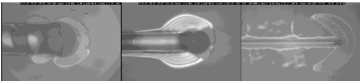
FIG. 3 – exemples d'endommagements par écaillage du film anti-rayure sur des massifs revêtus.
