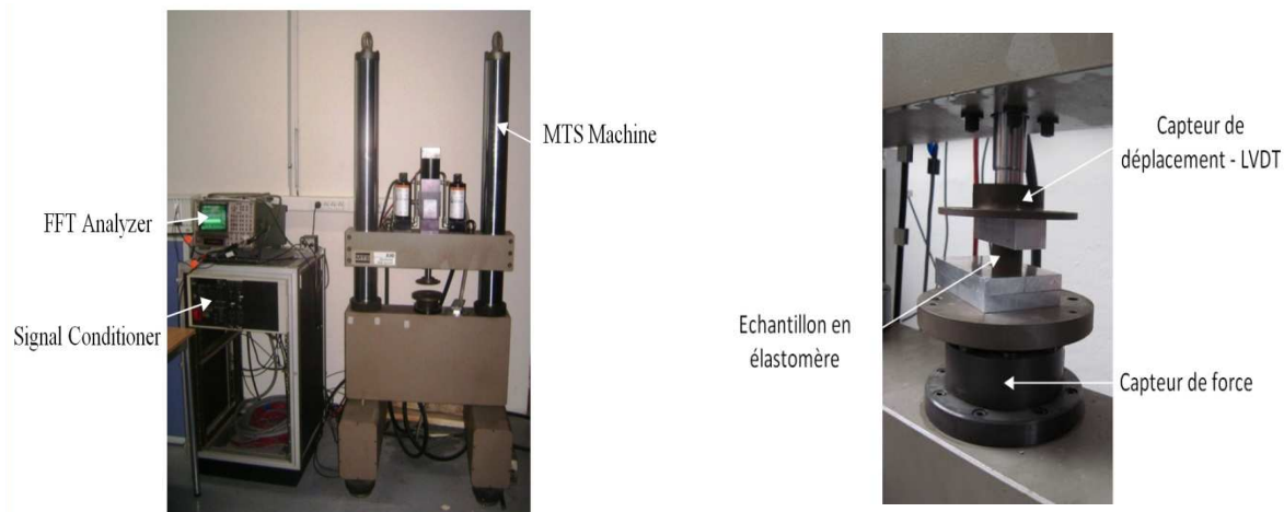
FIG. 1 – Dispositif du banc d'essai- machine d'essai MTS.
