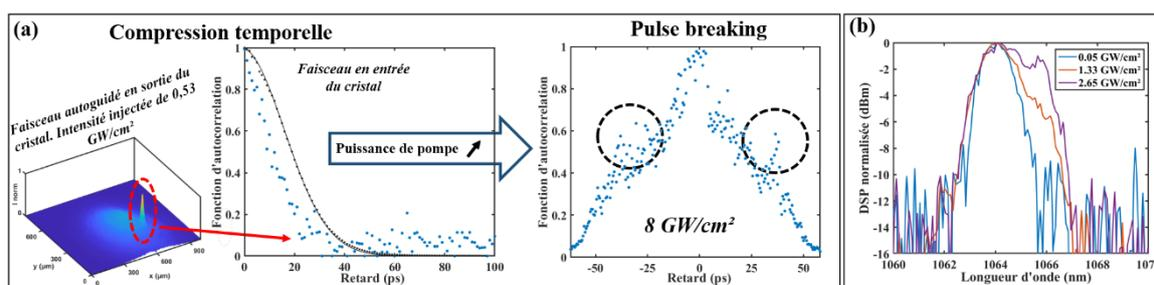
Fig. 2 : (a) Compression et « pulse breaking » ( $\Delta k = 0$  et polarisation d'entrée =  $63^\circ$ ) ; (b) Élargissement spectral, asymétrique, aux fréquences fondamentales ( $\Delta k > 0$  et polarisation d'entrée =  $69^\circ$ ).
