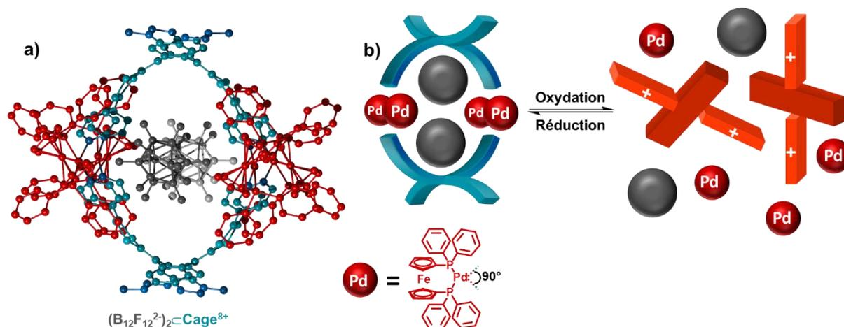
**Figure 2.** (a) Structure cristalline du complexe hôte-invité (anion)<sub>2</sub>⊂**Cage**<sup>8+</sup> (anion : B<sub>12</sub>F<sub>12</sub><sup>2-</sup>); (b) représentation schématique de l'expulsion des anions par désassemblage de la **Cage**<sup>8+</sup>.
