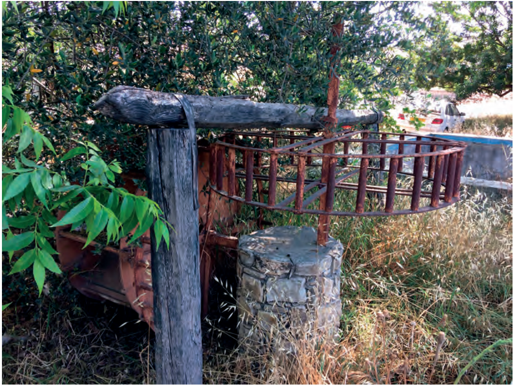
Fig. 72 — Roue à augets et son système d'actionnement, déplacée à côté du puits où elle a été remplacée par une pompe (Pseuda, 2018).
